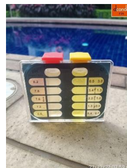
ภาพที่ 2-29 อุปกรณ์ตรวจวัด pH และคลอรีน ในสระว่ายน้ำ
